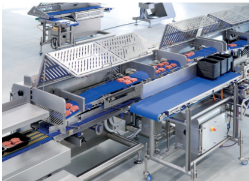
Entstapeln und Zuführen von Trays um die Hamburger in der richtigen Stückzahl aufzunehmen.
