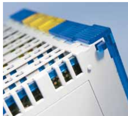
Die Querverriegelung kann durch einfaches Vorziehen der Modulabdeckung an der Vorderseite gelöst werden.
