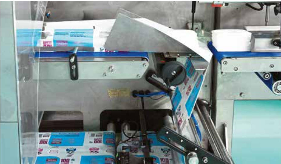
Die geschnittenen, gestapelten Feuchttücher werden in Plastikboxen oder wie hier im Bild in Schlauchbeutel verpackt und mit Entnahmedeckel versehen – bis zu 120 Packungen pro Minute.
