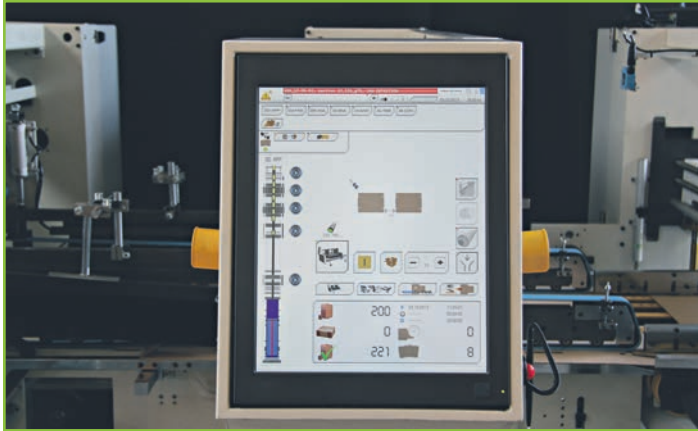
Über die 19-Zoll-Farb-Touchscreens lässt sich der Weg der Kartonblätter von Anfang bis Ende verfolgen (Echtzeit-Visualisierung). Zudem können so Anpassungen – wie beispielsweise die Faltrien-Geschwindigkeit – während des Prozesses erfolgen.
