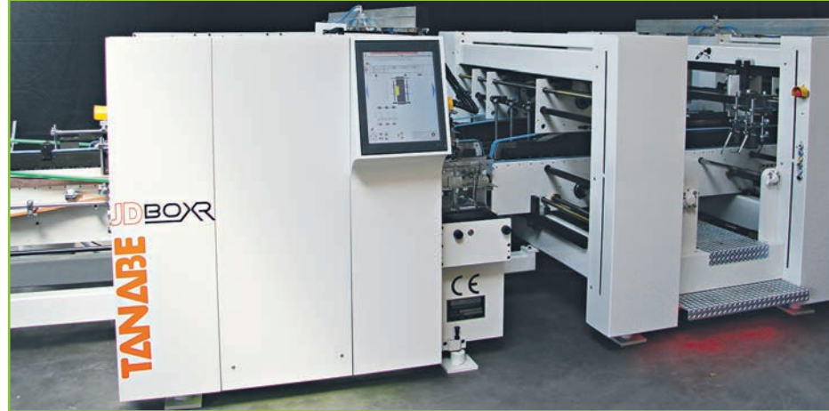
Für den Fall, dass ein Produktionsabschnitt in einen Fehlerzustand geht, schalten sich auf der Unterseite jeder Einheit LED-Lichter ein, um dies anzuzeigen.
