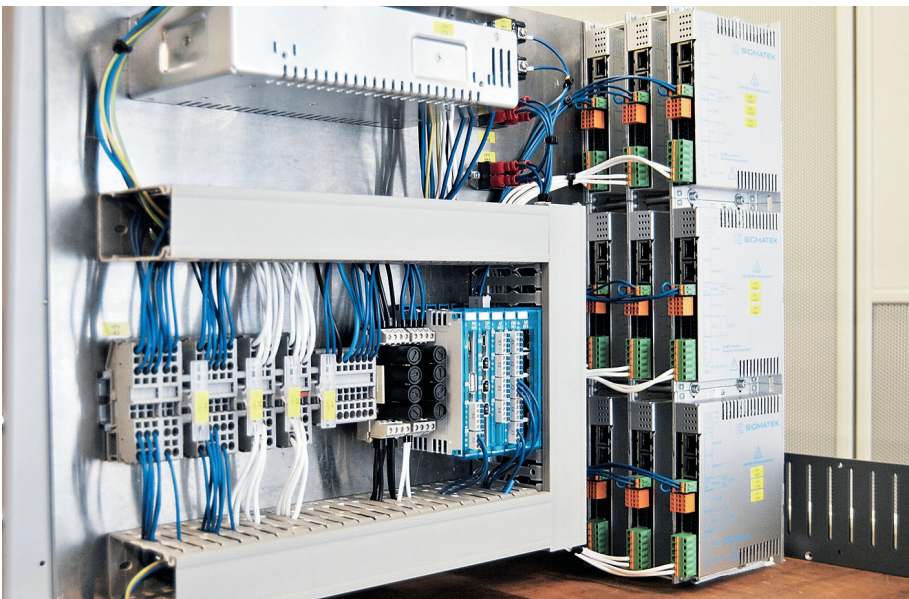
Beim Hage3D 140L ist das gesamte Automatisierungssystem in einem einzigen Schaltkasten untergebracht.
