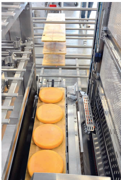
Der »Kaesaro S«-Pflegeroboter bearbeitet in der Stunde 200 Bretter mit drei oder vier Käseleiben pro Brett.
