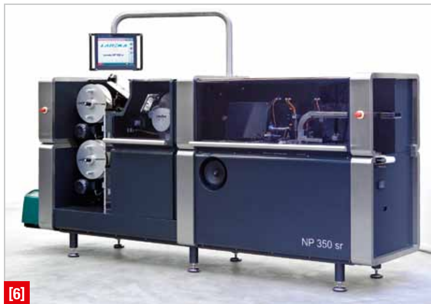
[6] Der kleinere Maschinentyp wurde speziell für die Verpackung der Schoko-Minis entwickelt. Sie umhüllt bis zu 350 Tafeln pro Minute mit Metall-/Papierfolie.
