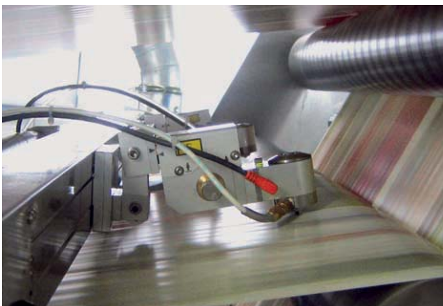
Intelligente Lösung: Bei der Längsleimung gleiten die Auftrageköpfe direkt auf der Papierbahn.
